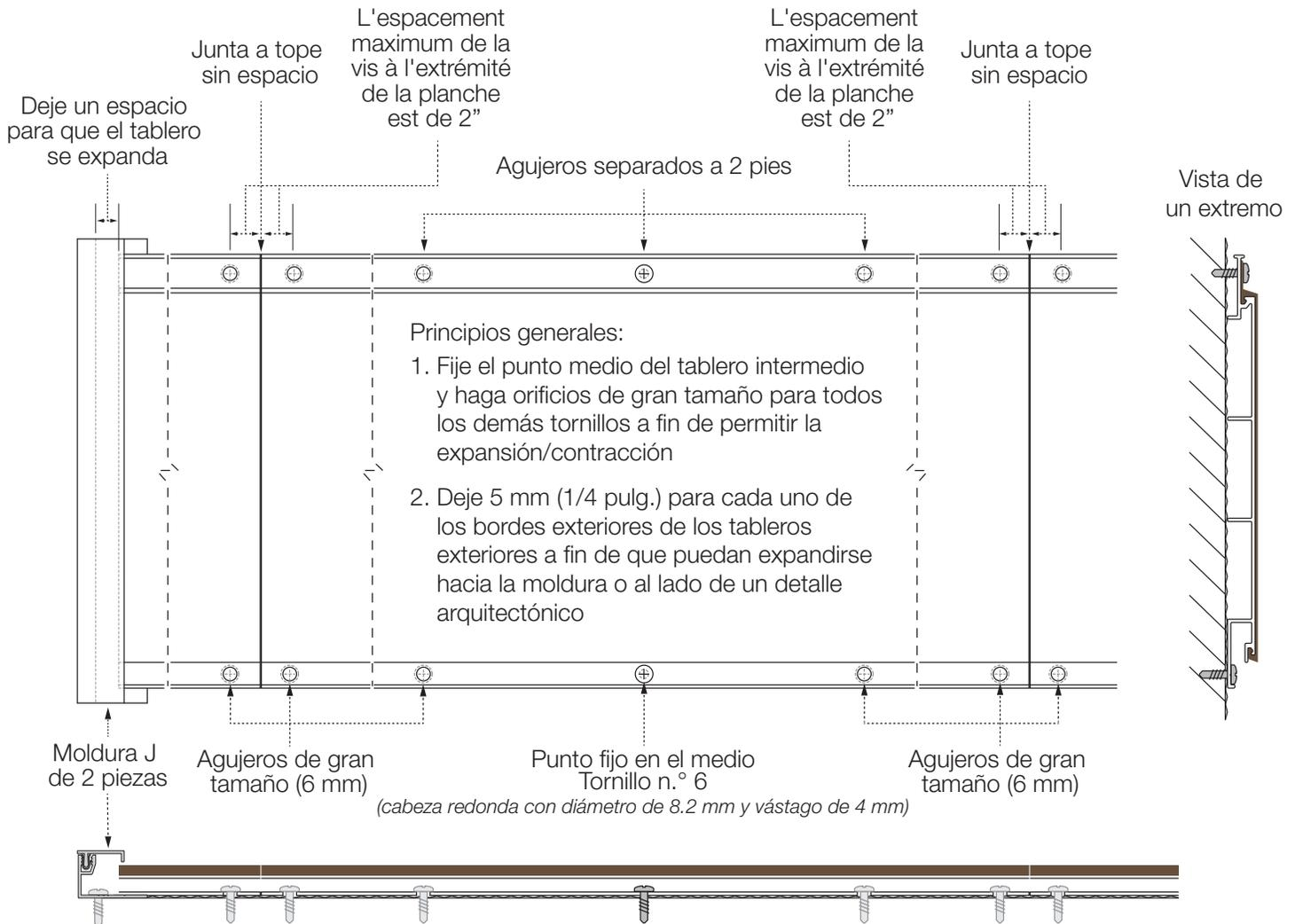
Los tableros exteriores se expanden hacia las piezas de la moldura o al lado de un detalle arquitectónico
