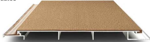
1. El drenaje de la condensación y la circulación del aire son esenciales para la funcionalidad de los productos de construcción. Aunque los tableros se pueden montar directamente en la pared o el sustrato, es una buena práctica de construcción montarlos sobre un recubrimiento de drenaje. No debe sellarse la parte superior ni inferior de la pared para permitir el drenaje y la circulación de aire.
