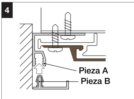
4. Con un mazo de goma, golpee la pieza B para que encaje en la pieza A
