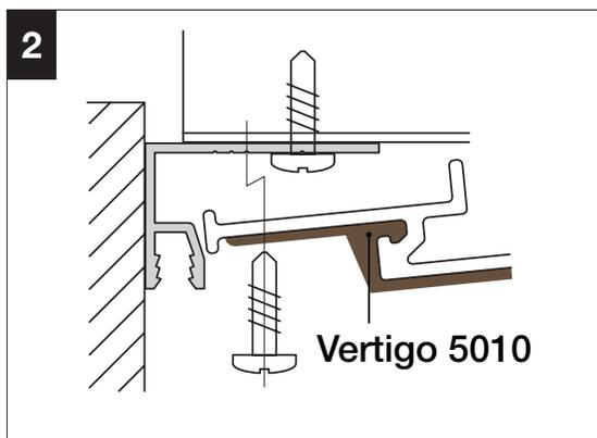
2. Atornille el tablero Geolam Vertigo a través de la moldura J en la pared cada 24 pulg. (60 cm)
