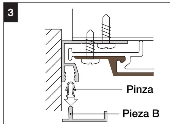
3. Coloque las pinzas de metal en la pieza B cada 16 pulg. (40 cm) como se muestra
